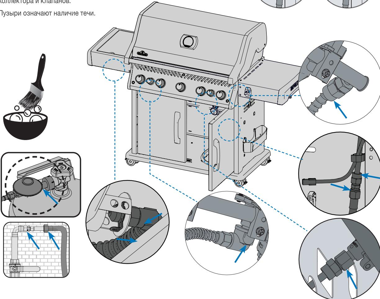
**ВНИМАНИЕ!** Никогда не используйте открытое пламя для испытания утечки газа. Искры или пламя могут стать причиной пожара, взрыва, порчи имущества, получения тяжких телесных повреждений или смерти.
